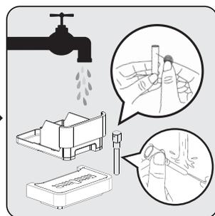
Опорожните контейнер для кофейной гущи и внешний поддон для капель. Промойте металлическую трубку теплой проточной водой и используйте иглу или щетину кисти, чтобы очистить отверстие. Промойте крышку сопла теплой проточной водой и очистите отверстие иглой или щетиной. После этого просушите их.
