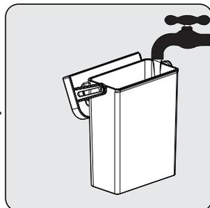
Промойте резервуар для воды пресной водой, затем наполните резервуар до максимального уровня и вставьте его обратно в машину. Убедитесь, что он вставлен полностью.
