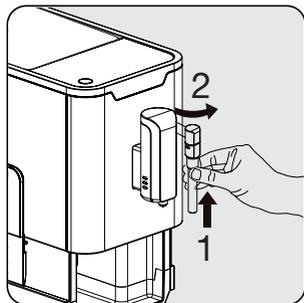
Установите металлическую трубку обратно на крышку сопла. Затем нажмите вверх, чтобы установить крышку сопла на место. И поверните ее вправо, чтобы заблокировать.
