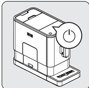
Включите прибор, нажав кнопку включения / выключения. Прибор включается в режиме ожидания и будет готов к работе, когда из дозатора кофе потечет немного горячей воды.
