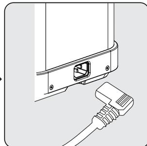
Размотайте и распрямите шнур питания, затем вставьте вилку в разъем, расположенный на задней панели машины. Вставьте другой конец шнура питания в розетку с подходящим напряжением питания.
