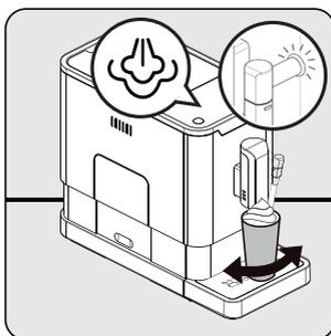
Нажмите кнопку пара. Индикатор пара будет мигать. После этого прибор нагреется и остатки воды стечут в поддон для сбора капель или другую емкость. После того, как световой индикатор пара перестанет мигать и будет гореть постоянным светом, поместите емкость с молоком под паровое сопло и погрузите паровое сопло примерно на 5 см в емкость. Пока выходит горячий пар, поверните емкость.
