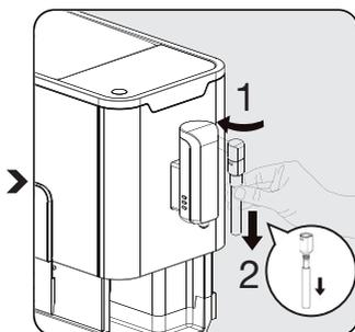
Снимите металлическую трубку, потянув ее вниз. Затем разблокируйте крышку сопла, повернув ее влево, чтобы снять крышку сопла и металлическую трубку.
