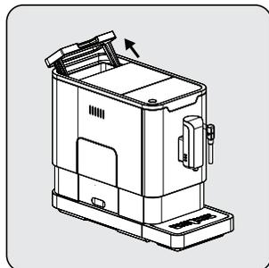
Поднимите резервуар для воды, взяв за ручку крышку.
