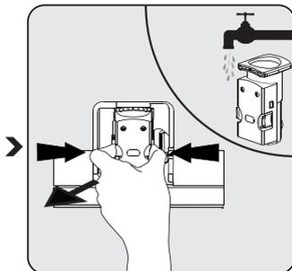
Нажмите на фиксирующие ручки и вытащите. Снимите часть для заваривания. Промойте часть для заваривания пресной водой. Затем высушите часть для заваривания.
